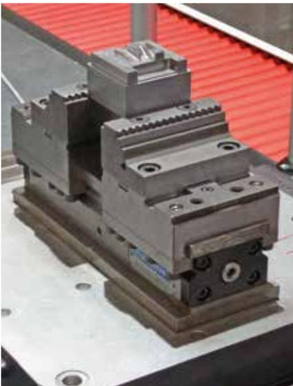
**Mechanischer Zentrischspanner MZC 220-80 E, Stufen-Wendebacken mit Gripleisten**
