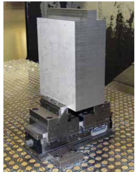
**Mechanischer Zentrischspanner MZC 220-80 E, Spannbacken mit HM-Gripeinsätzen**
